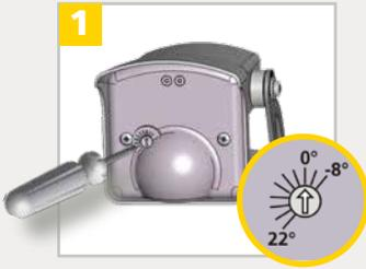
Beim Drehen dieser Schraube wird der Radarwinkel kleiner oder größer (von  $-8^\circ$  bis  $+22^\circ$ ).
