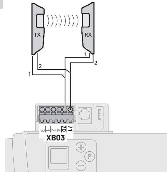
La commande détecte automatiquement une barrière lumineuse raccordée dès lors que l'alimentation électrique est raccordée. La barrière lumineuse peut être reprogrammée ultérieurement. Les barrières lumineuses non souhaitées doivent être déconnectées avant de raccorder l'alimentation électrique, car sinon la commande les détectera.
